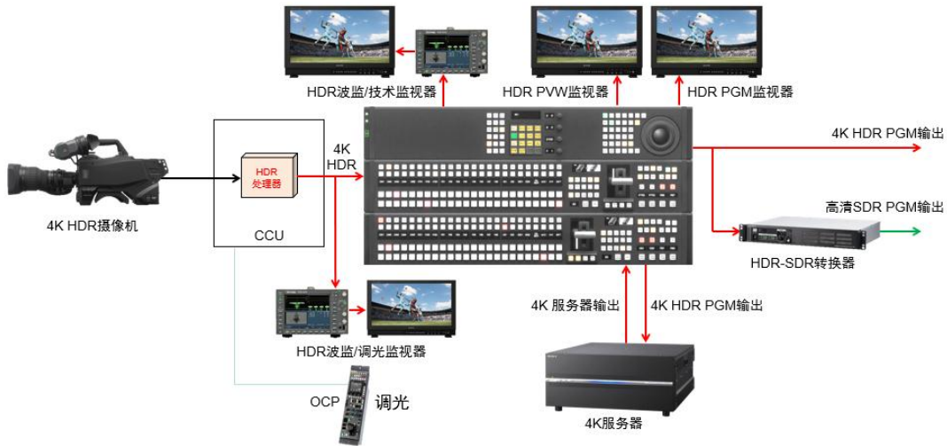
图 4 4K HDR 制作系统：用 HDR 调光制作 HDR
